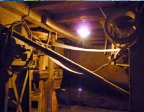
Der Antrieb geschieht über Rollen und Riemen
