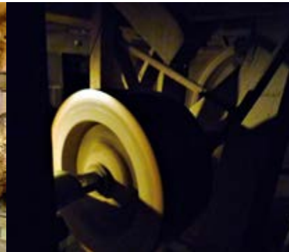
Eines der Schwungräder im Keller, zum Antrieb diverser Wellen
